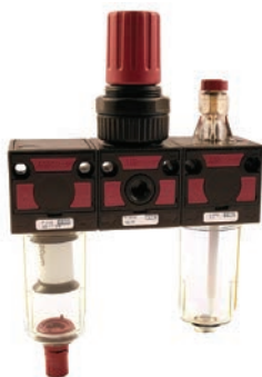
Serie 042 - F+R+L - 1/4" - modulair - 20µm - compacte transparante bowl
