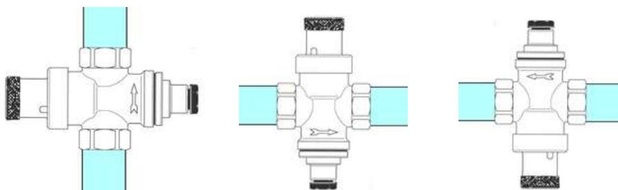
Tutti i riduttori di pressione sono testati prima di essere imballati; durante il test essi vengono tarati in uscita alla pressione di 3 bar; la pressione di uscita può essere facilmente modificata una volta che il riduttore è installato sull'impianto.
