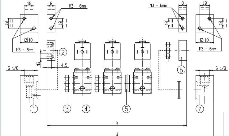
A = 16 + 18 x (N° SOLENOID VALVES - N° MAGNETVENTILE) + 1 x (N° REVERSER PLATES - N° HUNKEHRGRUPPE)
